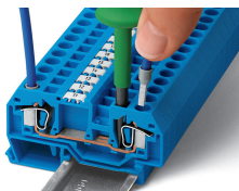
CAGE CLAMP® csatlakozás Vezeték behelyezése Érvéghüvelyes vezetékek esetén a vezeték névleges keresztmetszeténél egy mérettel nagyobb méretű sorkapcsot kell használni.
