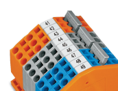
4 vezetékes átmenő sorkapocs, döntött típus, csoportképzés 3 ágú, fésűs áthidalókkal
